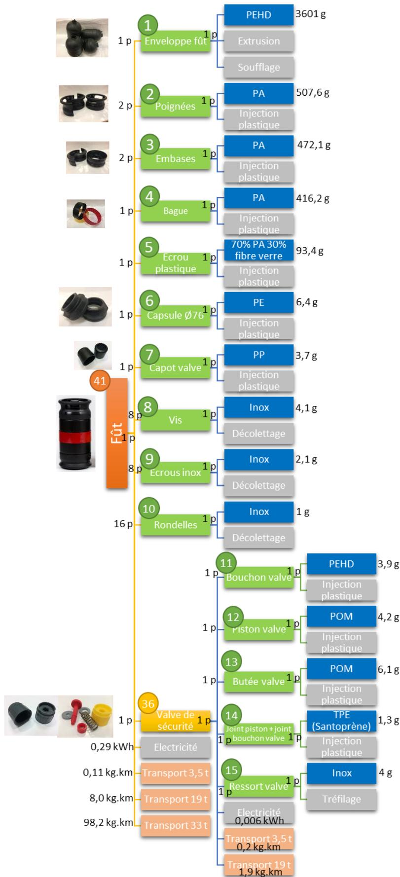
Figure 10 : Structuration de la modélisation dans Simapro et quantités de flux pour la fabrication du fût
